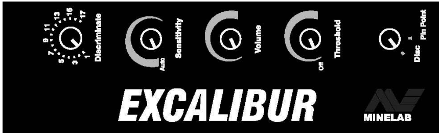
Figure 5 – Face avant de l'Excalibur et ses différents réglages
